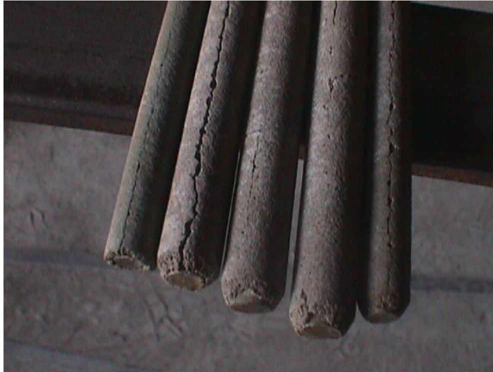
Eletrodos inoxidáveis apresentando trincas longitudinais
