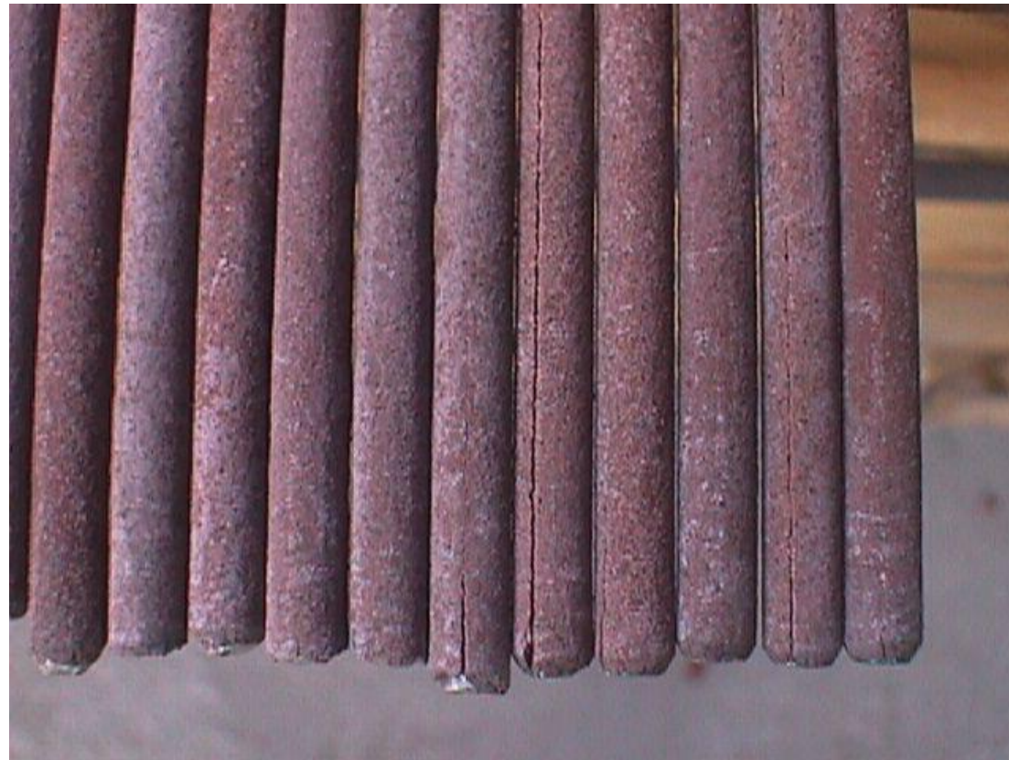
Eletrodos celulósicos que passaram por ressecagem
