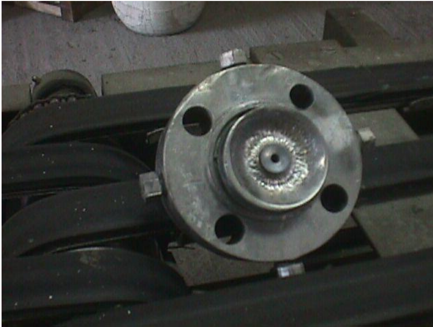
Porta bocal com os parafusos de ajustes da concentricidade
