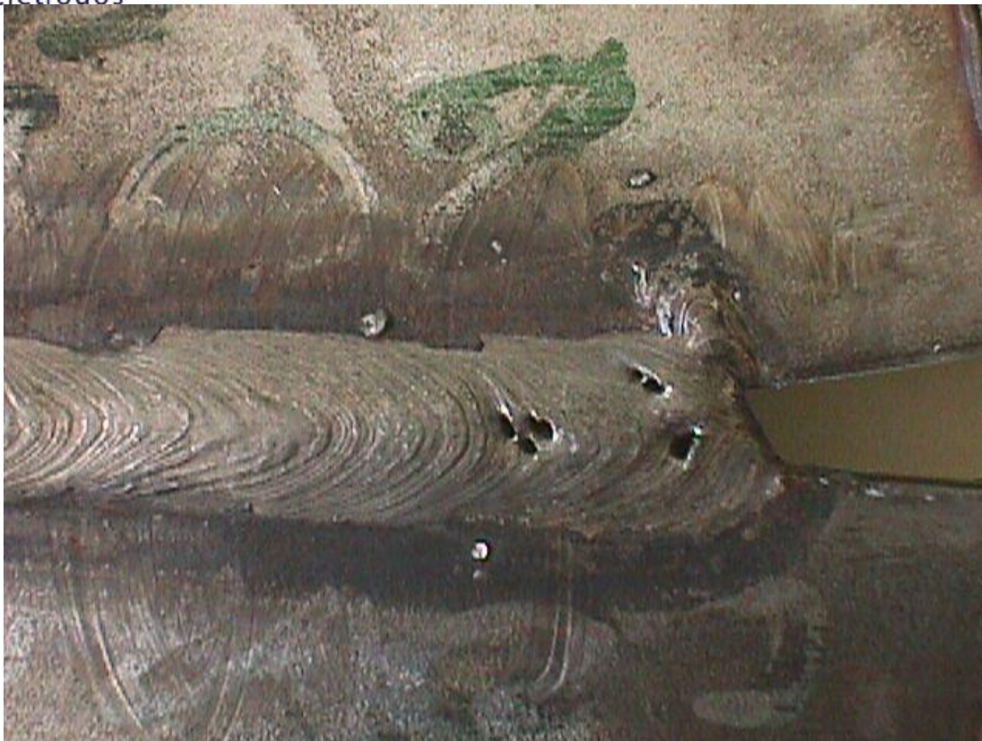
Porosidade no cordão devido a umidade dos eletrodos
