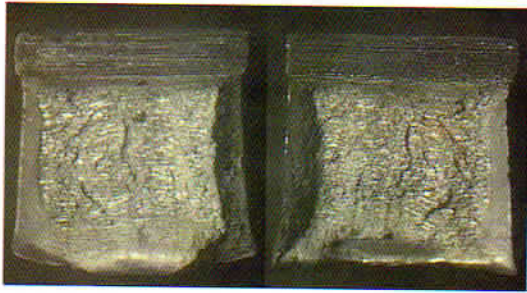
Figura 8. Resultados dos testes de impacto do metal de solda produzido com o eletrodo impermeável.
