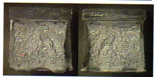
Figura 8. Resultados dos testes de impacto do metal de solda produzido com o eletrodo impermeável.
