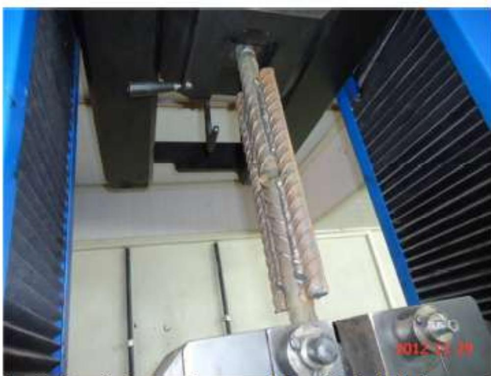
*Ensaio de tração do corpo de prova no laboratório da Techadam.*
