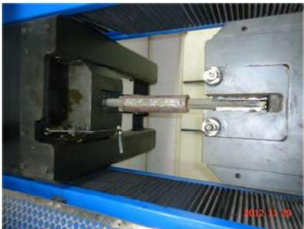
*Ensaio de tração do corpo de prova.*
