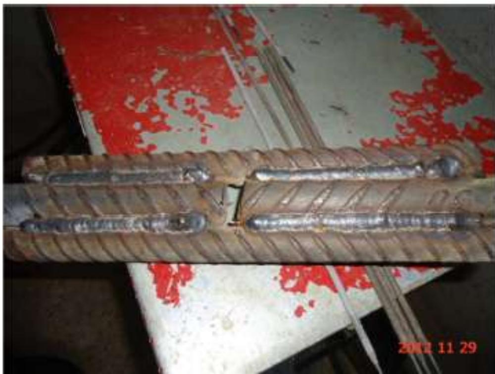
*Conclusão da solda do corpo de prova.*
