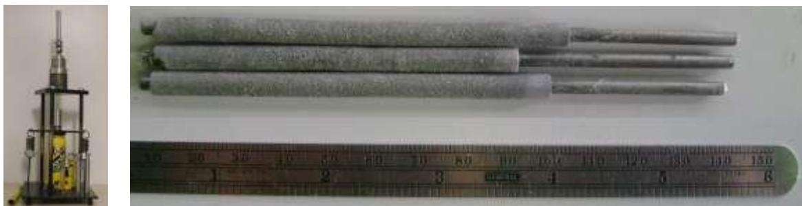
Figura 2. Máquina usada em laboratório para fabricação de eletrodos e exemplos de eletrodos fabricados (B1).
